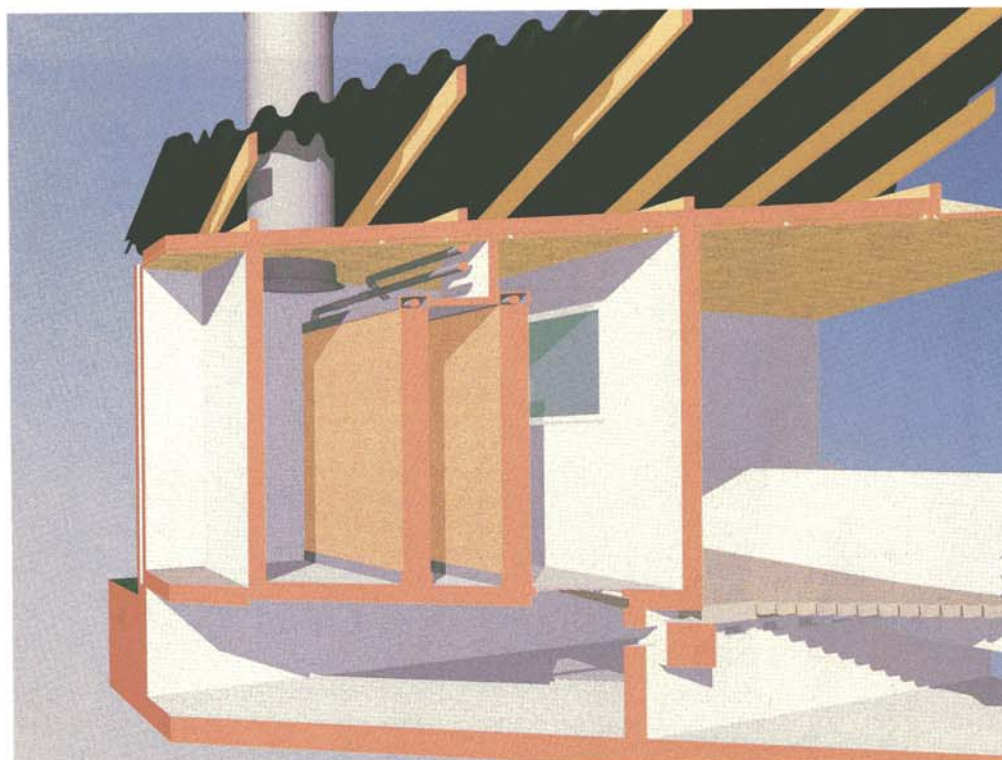
Skitse af rensenhed. Luften, der suges ud under gulvet, føres gennem de to filtre og videre op i afkastningskorstenen.
